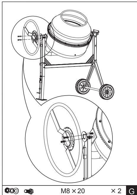
Установите опрокидывающее колесо с фиксирующей тарелкой на фланце рамы и закрепите двумя шестигранными болтами M8x20 с плоскими и стопорными шайбами и гайками.
