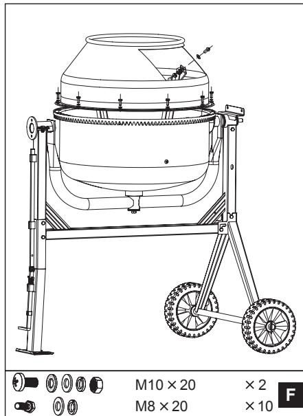
1. Установите верхний барабан на нижний над ободом таким образом, чтобы совместились монтажные отверстия, а также стрелки в обоих частях.
