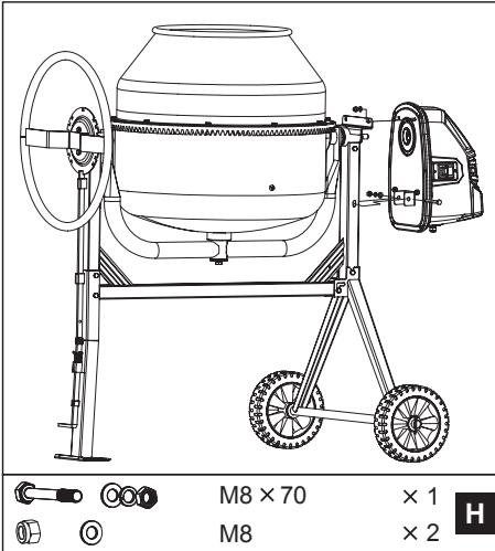
Совместив шпоночные пазы, надвиньте коробку редуктора на вал - шестерню. Наверните гайку с плоской и стопорной шайбами на каждую резьбовую шпильку. Прикрепите кронштейн нижнего корпуса болтом M8x70 с плоской и стопорной шайбами и гайкой.
