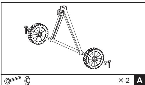
1. Наденьте колёса на оси и зафиксируйте их пружинящими фиксаторами.
