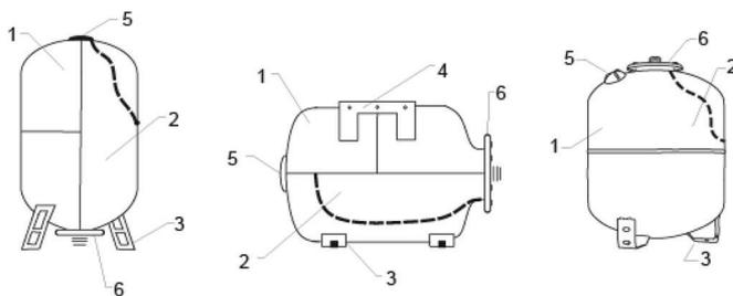
Гидроаккумуляторы выпускаются двух типов - горизонтальные и вертикальные. Горизонтальные гидроаккумуляторы оснащены площадкой для крепления насоса (4).
